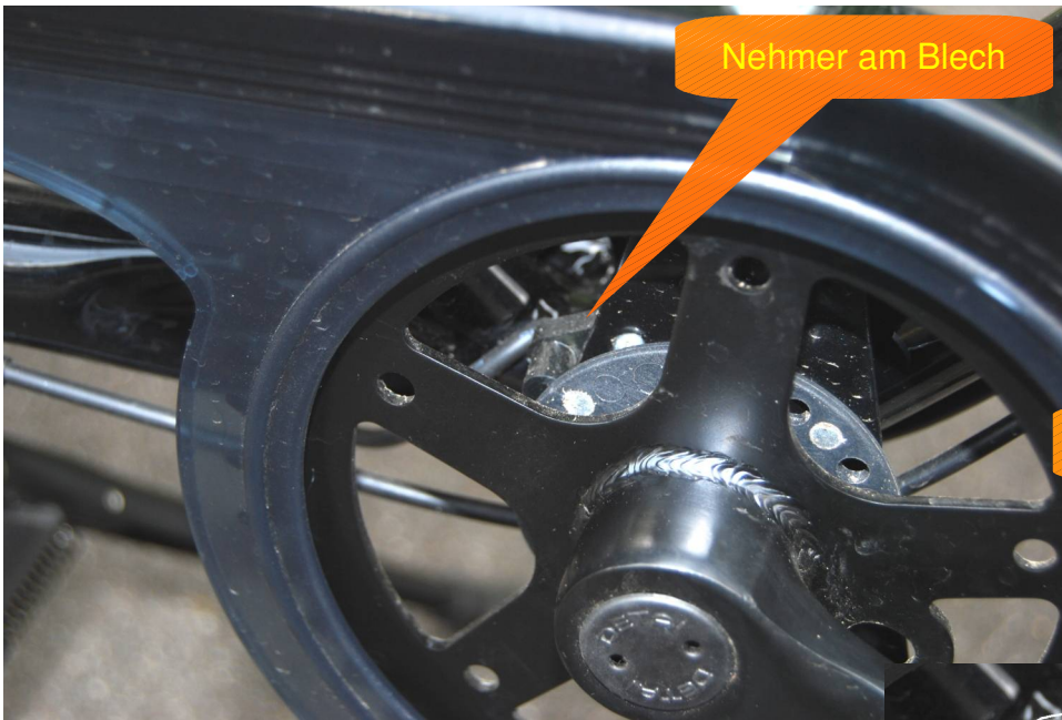
Pedalsensor auf der Achse
